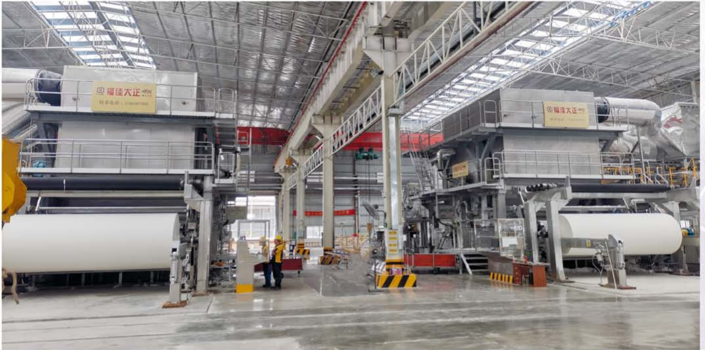
运行中的新月纸机，幅宽4200mm，车速1400m/min，抄造克重11g/m 2
