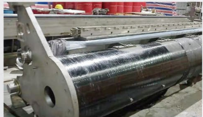
新型碳纤维刮刀梁 应用于江西五星纸业5600/1100白卡纸项目（国产设备首创）
