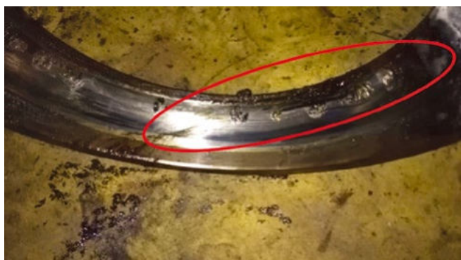
图4 轴承外圈剥落
