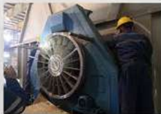
纸机干部导辊 表面腐蚀修复
