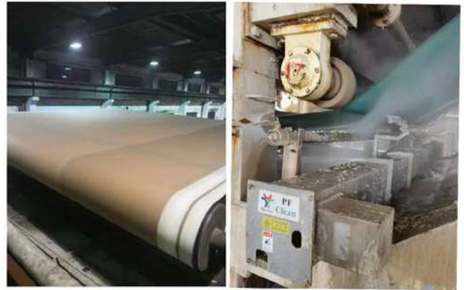
毛布/成型网在线清洗系统
