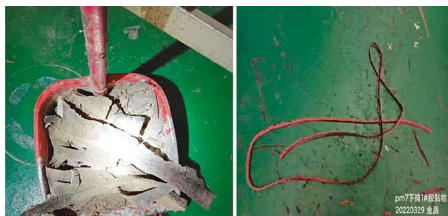
图10 PM7烘缸刮刀胶黏物形态对比
