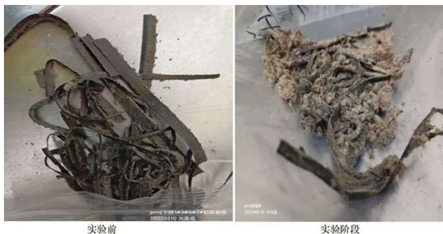
图9 PM6烘缸刮刀胶黏物形态对比
