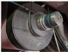
真空泵轴类 磨损在线修复
