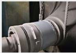
纸机烘缸 轴承位磨 损在线修复
