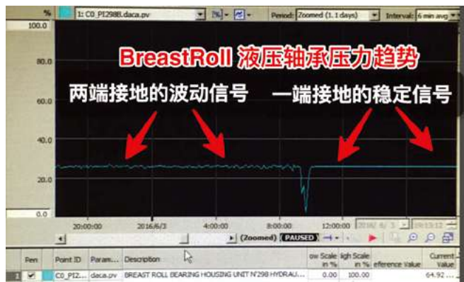
图3 双端接地与单端接地信号对比
