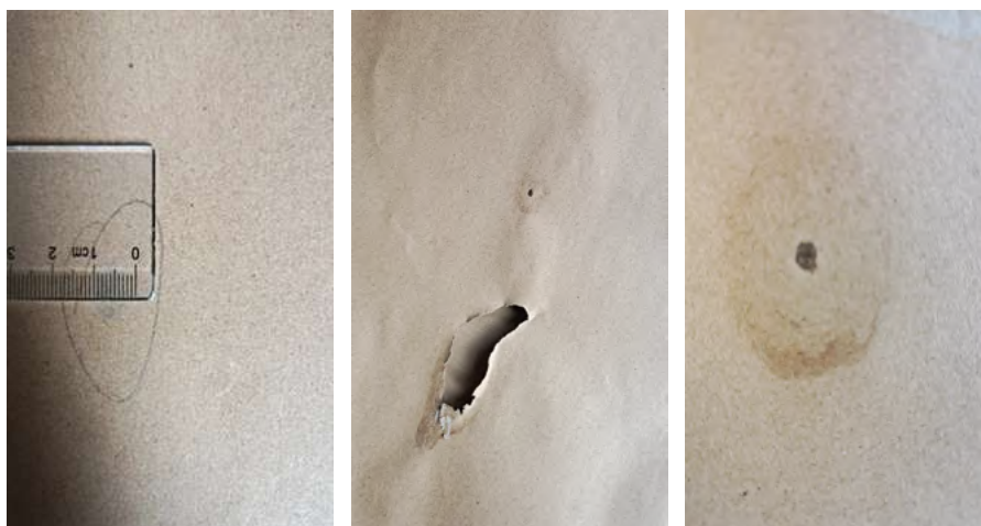
图4 胶黏物引起的纸病照片
