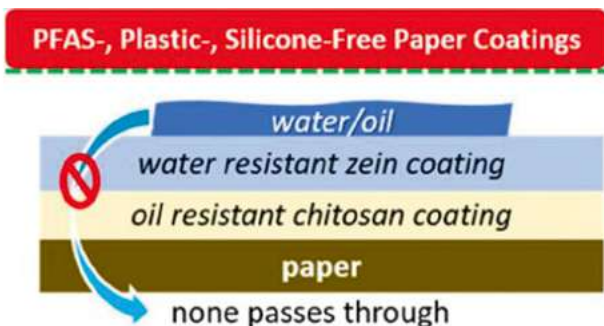
图2 玉米醇溶蛋白(顶)和壳聚糖(底)双层涂布 [68]
