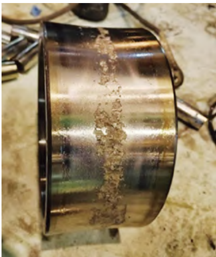
图5 烘缸操作侧轴承剥落
