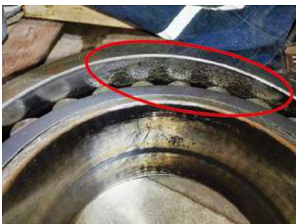
图6 烘缸传动侧轴承剥落
