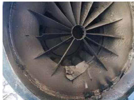
图8 风机导流板掉落
