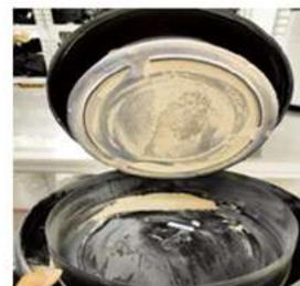
总成测试结束后灰尘状态
